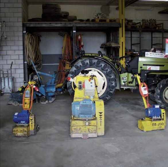
Bei diesem Untergrundvorbereitungs-Verfahren wird die Beschichtung oder oberste Schicht abgetragen. Die Fräswalzen der Feinfräsen weisen einen engen Linienabstand auf. Dadurch entsteht ein sehr feines Fräsbild mit geringer Rautiefe. Beim Feinfräsen werden je nach Anforderung eine Beschichtung oder einige Millimeter des Untergrundes abgetragen.
