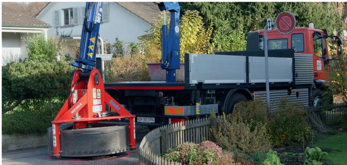
■ Fahrzeug mit Thermosilo für Asphalt.
